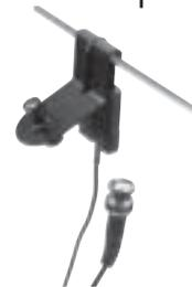
Fensterklemmfuß zur Aufnahme von Antennen mit BNC-Anschluß und 2,50 m RG 174-Anschlusskabel mit montiertem BNC-Stecker. Durch Verwendung des verlustarmen RG 174/U-Kabels optimal geeignet für Amateurfunk, Scanner und CB-Geräte.
