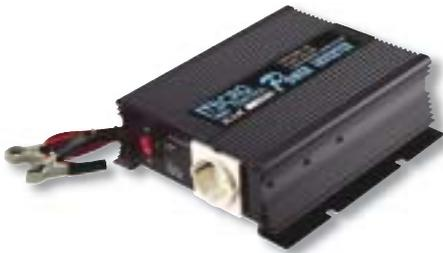
Wechselrichter für max. 600 W Leistung mit Überlastanzeige (LED), Ventilator zur Kühlung und optischer Batterieleeranzeige. Für alle Elektrogeräte mit 2-poligem Europastecker, Computer und Zubehör, kleine Elektrowerkzeuge, wie Winkelschleifer, Schrauber, Stichsäge, Standard-Bohrmaschinen, Lötkolben, Wasserpumpen, Kühlschrank, sowie als 230 V Wohnmobil-Bordnetz.
