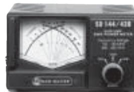
Duoband-Stehwellen- und Leistungsmeßgerät mit Kreuzzeigerinstrument. Frequenzbereich 130 - 180 MHz/ 400 - 480 MHz. Hohe Anzeigegenauigkeit, max. Eingangsleistung 1000 W.
