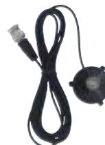
Mini-Magnetfuß (Ø 35 mm) mit enormer Haftkraft. Mit BNC-Anschluss zur Aufnahme von Gummiwendel- und kürzeren Stabantennen. Am 2,4 m langen, verlustarmen RG 174 Anschlusskabel ist ein BNC-Stecker montiert.
