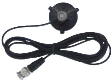
Mini-Magnetfuß (Ø 35 mm) mit enormer Haftkraft. Mit BNC-Anschluss zur Aufnahme von Gummiwedel- und kürzeren Stabantennen. Am 2,40 m langen, verlustarmen RG 174 Anschlusskabel ist ein BNC-Stecker montiert.
